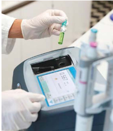
Die Teichwasseranalyse mit Spektrometer liefert umfassende Ergebnisse.
